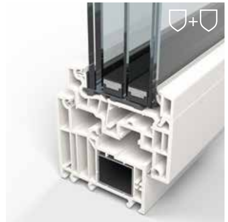
Schnitt durch ein Fenster mit Dreifach-Isolierglas in einer Ausführung mit außen und innen Verbundsicherheitsglas Multiprotect, Aufbau 44.2Sm-13-4F-13-66.2Sm
