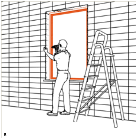
Der Blendrahmen wird im Rohbau, in der so genannten nassen Bauphase, in die Laibung montiert.
