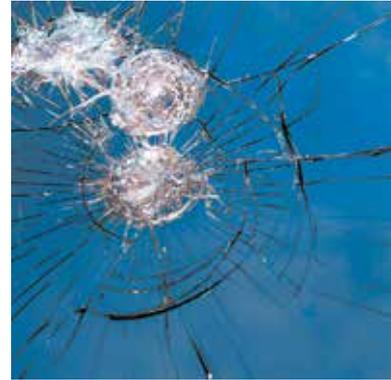
Zusätzliche Sicherheit bietet Ihnen unser Multiprotect-Glas. Es besteht aus zwei Glasscheiben, die mit einer hochreißfesten Folie verklebt sind. Das erschwert das Durchbrechen des Glases, bindet Glassplitter und beugt Verletzungen vor. Zusätzlich dämmt das Multiprotect-Glas durch das hohe Scheibengewicht den Lärm.
